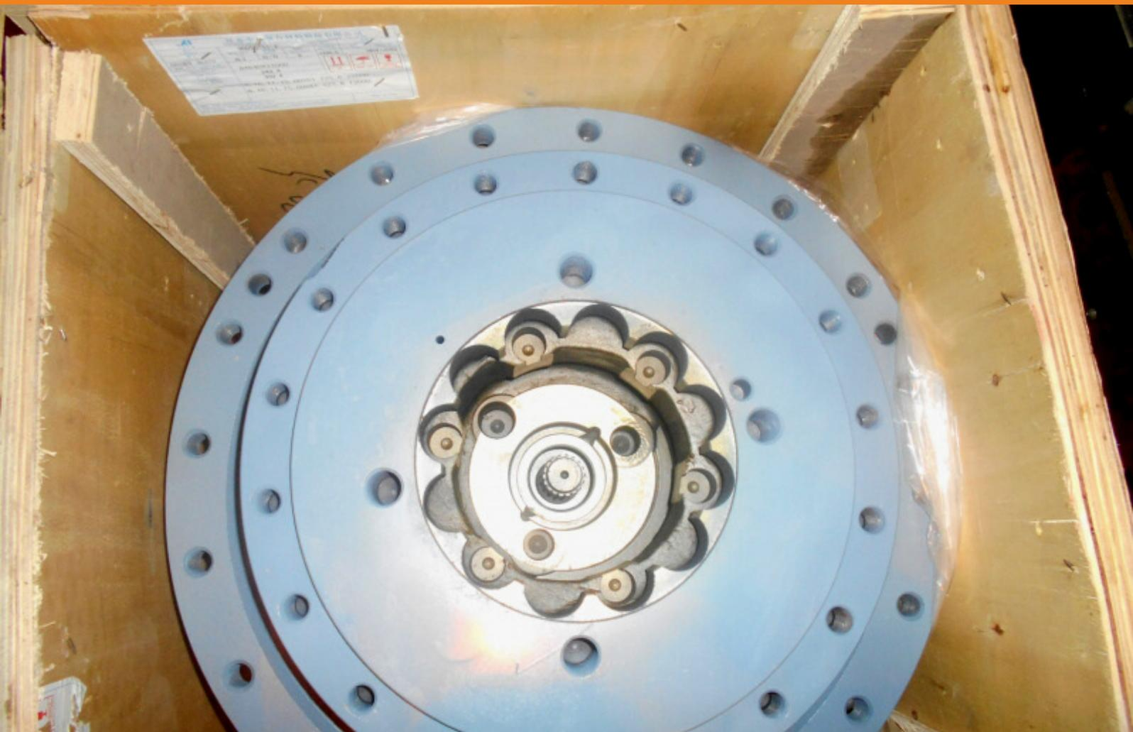
**Внимательно осмотрите место стыковки корпуса бортового редуктора с корпусом гидромотора. Если вы обнаружите утечку, то это может свидетельствовать о более серьезных проблемах. В этом случае немедленно прекратите использование машины и обязательно замените уплотнение.**
