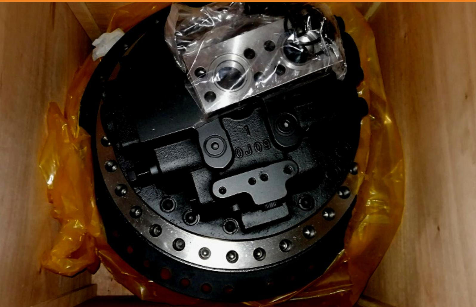
**Проверяйте натяжение гусениц. Перетянутые гусеницы приводят к износу подшипников бортового редуктора, износу плавающего уплотнения и преждевременному выходу бортового редуктора из строя.**
